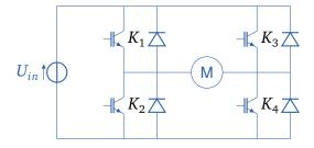
Les ensembles IGBT/Diodes  $K_i$  seront modélisés par des interrupteurs comme sur le cours.
